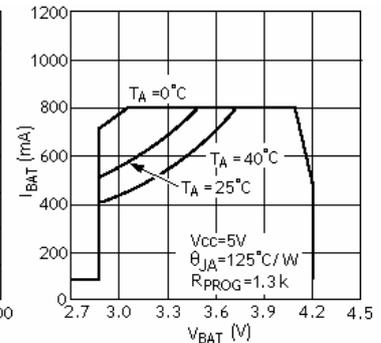
充电电流与电源电压的关系曲线
